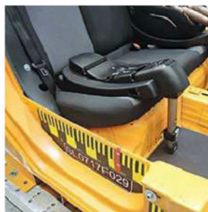
Autosedačka Recaro Optia se při nárazu neudržela v základně SmartClick a byla katapultována i s figurínou dítěte dopředu. Na sedadle zůstala po nárazu pouze základna.
