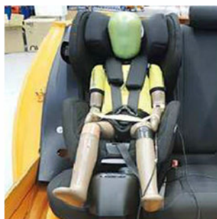
Autosedačka Recaro Optia se při nárazu neudržela v základně SmartClick a byla katapultována i s figurínou dítěte dopředu. Na sedadle zůstala po nárazu pouze základna.
